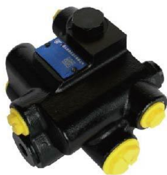
DACV*- F25L 双路充液阀 DUAL LIQUID FILLING VALVE 公称压力 NOMINAL PRESSURE : 20MPa 公称流量 NOMINAL FLOW RATE : 110L/min 公称通径 NOMINAL SIZE : 25mm
