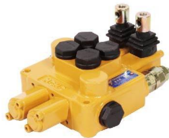
ZD*-10 系列整体式多路阀 MONOBLOCK VALVE 公称压力 NOMINAL PRESSURE : 20MPa 公称流量 NOMINAL FLOW RATE : 40L/min 阀杆行程 SPPOOL STROKE : 5+5mm
