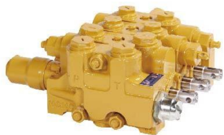
DF28-15 系列多路换向阀 DIRECTIONAL VALVE 公称压力 NOMINAL PRESSURE : 25MPa 公称流量 NOMINAL FLOW RATE : 50L/min 阀杆行程 SPPOOL STROKE : O型5+5mm Q型6.5+6.5mm 阀蕊直径 THE VALVE CORE DIAMETER : \phi 19
