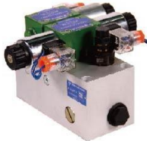
HCFK3 液压集成阀块 HYDRAULIC BLOCK VALVE 公称压力 NOMINAL PRESSURE : 20MPa 公称流量 NOMINAL FLOW RATE : 40L/min 控制电压 CONTROL VOLTAGE : DC24V/12V
