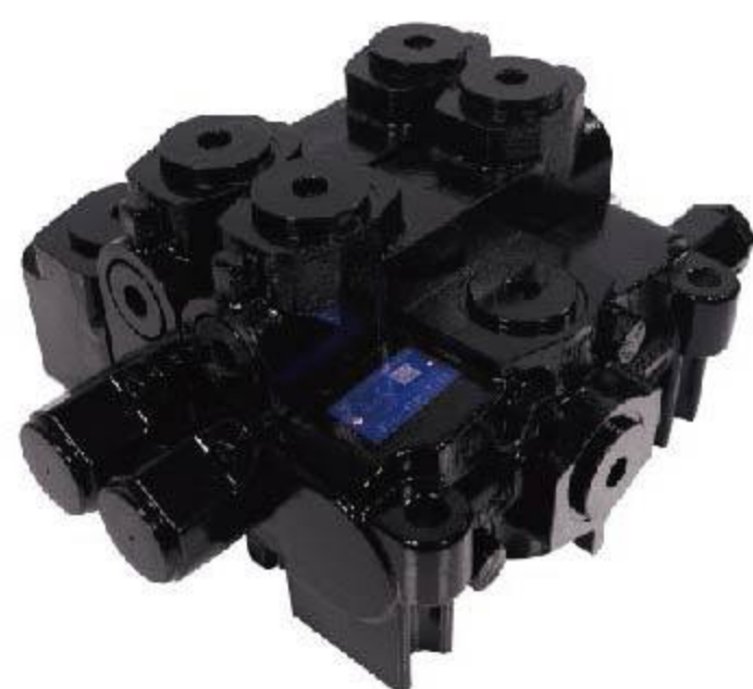
SDV*-70 系列多路换向阀 DIRECTIONAL VALVE 公称压力 NOMINAL PRESSURE : 31.5MPa 公称流量 NOMINAL FLOW RATE : 260L/min 阀杆行程 SPOOL STROKE : 12+12mm
