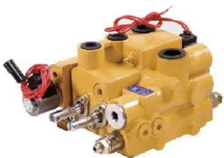
CDC*-15 系列多路换向阀 DIRECTIONAL VALVE 公称压力 NOMINAL PRESSURE : 20MPa 公称流量 NOMINAL FLOW RATE : 65L/min 阀杆行程 SPPOOL STROKE : 7+7mm
