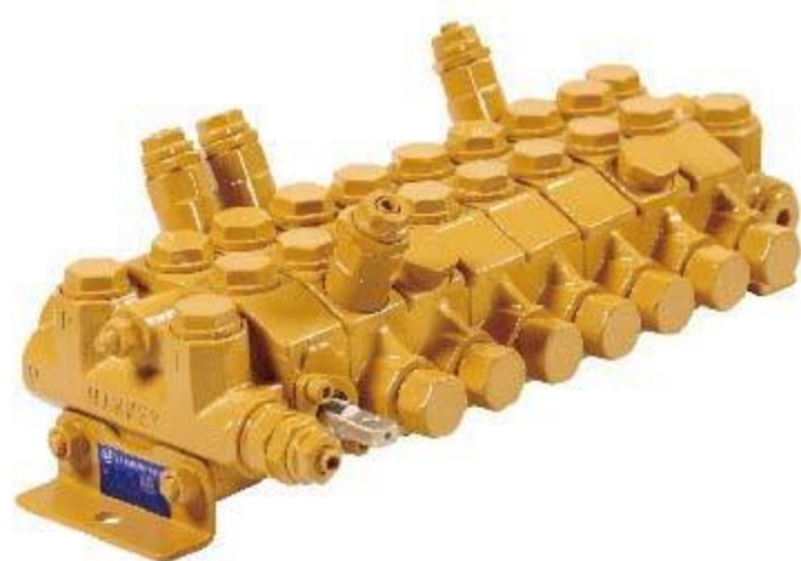
EDL*-10 系列多路换向阀 DIRECTIONAL VALVE 公称压力 NOMINAL PRESSURE : 20MPa 公称流量 NOMINAL FLOW RATE : 40L/min 阀杆行程 SPPOOL STROKE : 5+5mm
