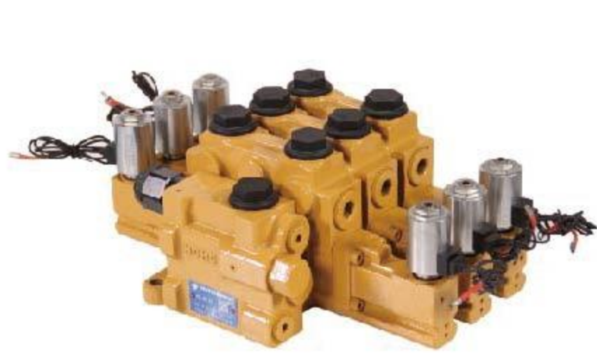
DYDL*-15 系列电液多路换向阀 ELECTRIC HYDRAULIC VALVE 公称压力 NOMINAL PRESSURE : 20MPa 公称流量 NOMINAL FLOW RATE : 65L/min 阀杆行程 SPPOOL STROKE : 7+7mm
