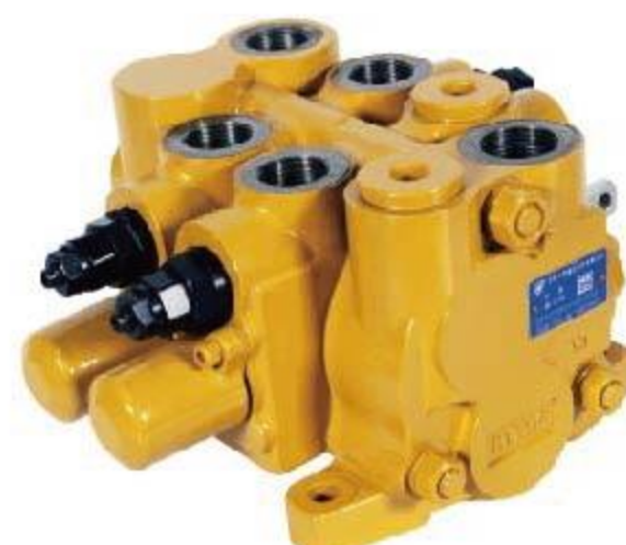
DL*-20 系列多路换向阀 DIRECTIONAL VALVE 公称压力 NOMINAL PRESSURE : 20MPa 公称流量 NOMINAL FLOW RATE : 160L/min 阀杆行程 SPOOL STROKE : 8+8mm
