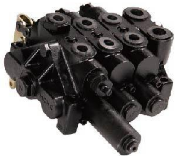
DFG*-15 系列多路换向阀 DIRECTIONAL VALVE 公称压力 NOMINAL PRESSURE : 20MPa 公称流量 NOMINAL FLOW RATE : 50L/min 阀杆行程 SPPOOL STROKE : O型8+8mm Q型5+5+5mm
