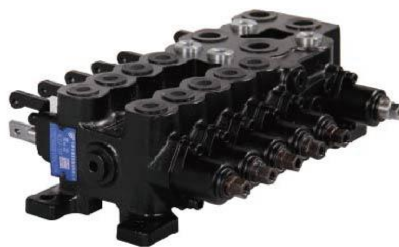
HCZTF-120 系列多路换向阀 DIRECTIONAL VALVE 公称压力 NOMINAL PRESSURE : 25MPa 公称流量 NOMINAL FLOW RATE : P-V120L/min 阀杆行程 SPOOL STROKE : 8+8mm
