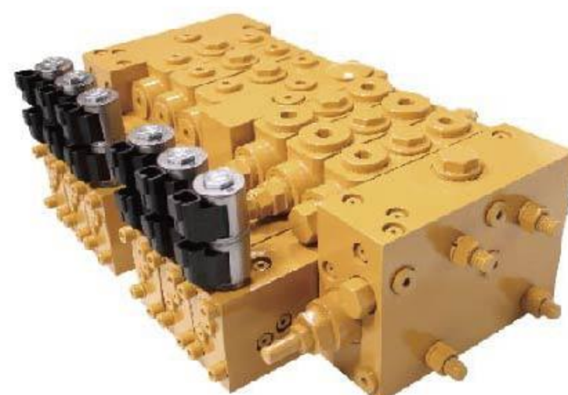
HCBF*-20 系列多路换向阀 DIRECTIONAL VALVE 公称压力 NOMINAL PRESSURE : 20MPa 公称流量 NOMINAL FLOW RATE : 160L/min 阀杆行程 SPOOL STROKE : 8+8mm
