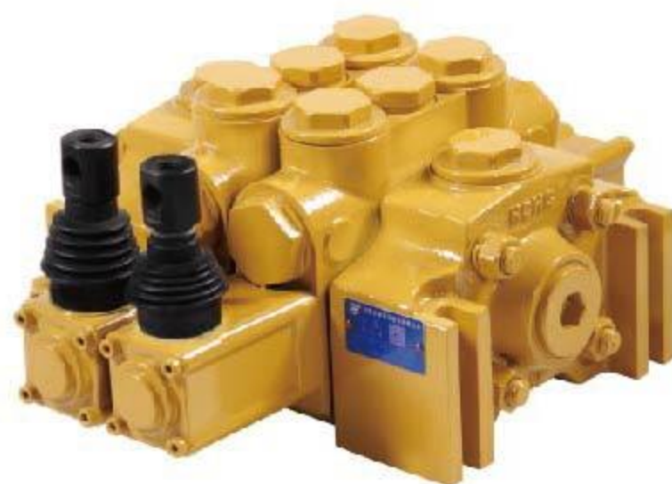
EDL*-25 系列多路换向阀 DIRECTIONAL VALVE 公称压力 NOMINAL PRESSURE : 25MPa 公称流量 NOMINAL FLOW RATE : 200L/min 阀杆行程 SPOOL STROKE : 8+8mm
