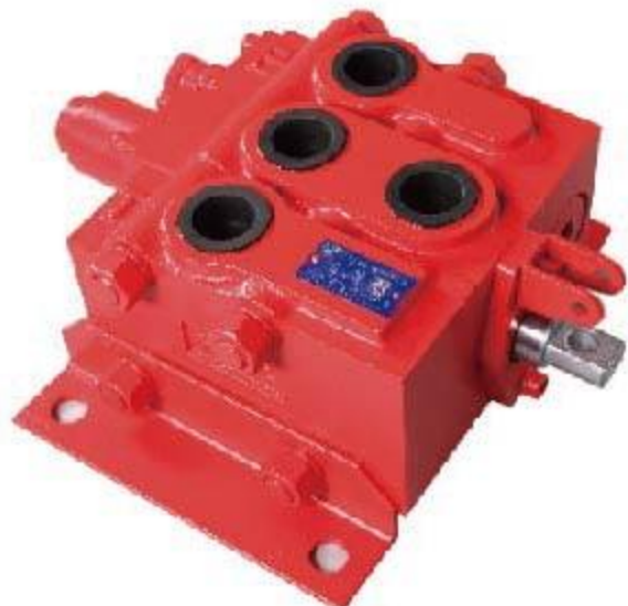
ZS*-25 系列多路换向阀 DIRECTIONAL VALVE 公称压力 NOMINAL PRESSURE : 20MPa 公称流量 NOMINAL FLOW RATE : 160L/min 阀杆行程 SPOOL STROKE : 6+6mm
