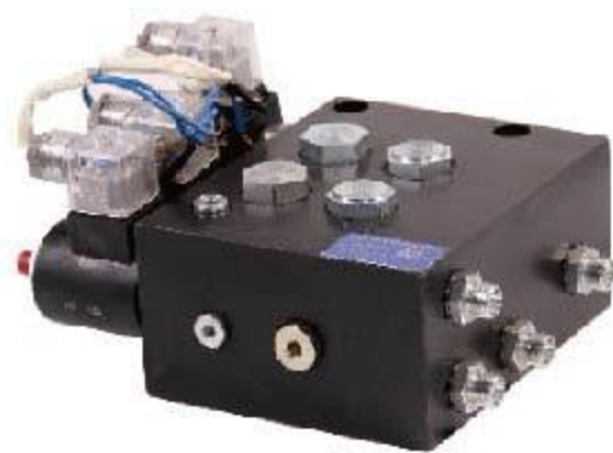
HCFK2 液压集成阀块 HYDRAULIC BLOCK VALVE 公称压力 NOMINAL PRESSURE : 20MPa 公称流量 NOMINAL FLOW RATE : 40L/min 控制电压 CONTROL VOLTAGE : DC24V/12V
