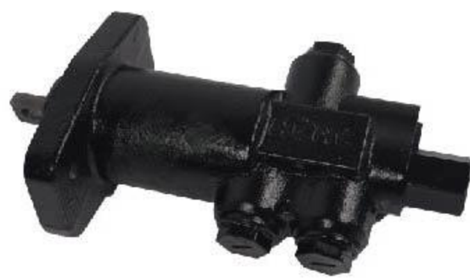
HCZFR*-E25L 反向调节液压制动阀 REVERSE REGULATION HYDRAULIC BRAKE VALVE 公称压力 NOMINAL PRESSURE : 16MPa 公称流量 NOMINAL FLOW RATE : 25L/min
