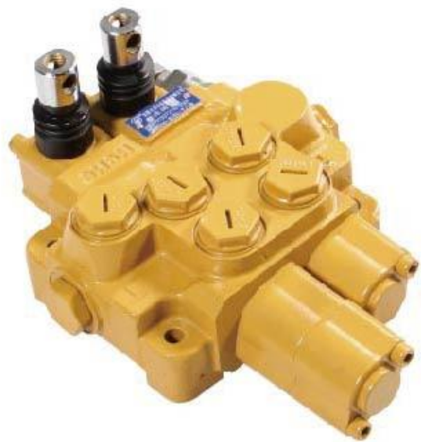
ZDG-15 系列整体式多路阀 MONOBLOCK VALVE 公称压力 NOMINAL PRESSURE : 20MPa 公称流量 NOMINAL FLOW RATE : 50L/min 阀杆行程 SPPOOL STROKE : 5+5mm
