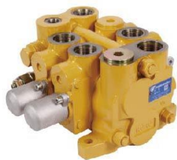
CDB*-20 系列多路换向阀 DIRECTIONAL VALVE 公称压力 NOMINAL PRESSURE : 20MPa 公称流量 NOMINAL FLOW RATE : 160L/min 阀杆行程 SPOOL STROKE : 8+8mm
