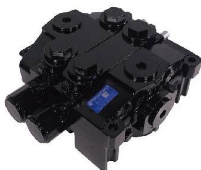
SDV*-40 系列多路换向阀 DIRECTIONAL VALVE 公称压力 NOMINAL PRESSURE : 31.5MPa 公称流量 NOMINAL FLOW RATE : 150L/min 阀杆行程 SPOOL STROKE : 10+10mm
