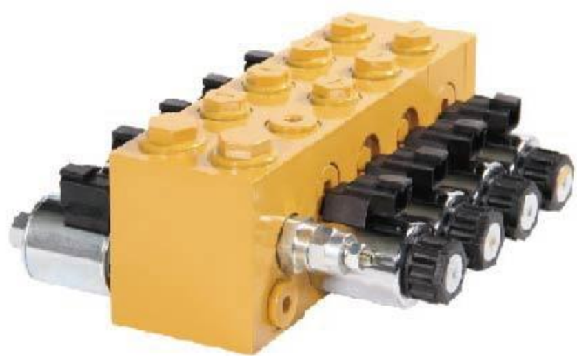
DCF 系列多路换向阀 DIRECTIONAL VALVE 公称压力 NOMINAL PRESSURE : 31.5MPa 公称流量 NOMINAL FLOW RATE : 50L/min 控制电压 CONTROL VOLTAGE : DC24V/DC12V
