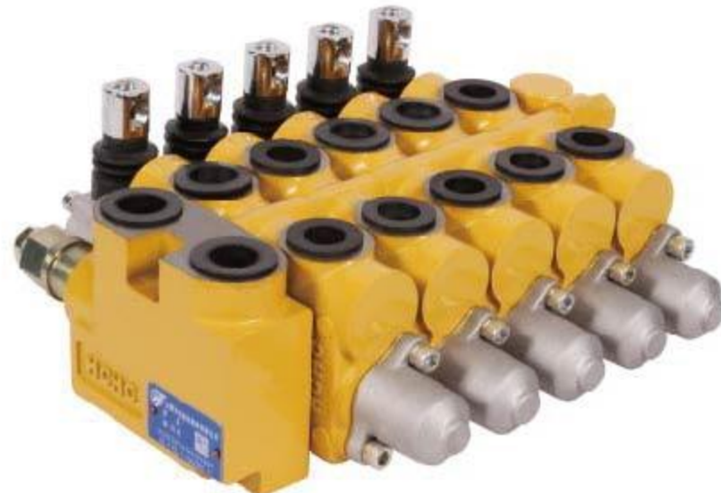
DL*-15 系列多路换向阀 DIRECTIONAL VALVE 公称压力 NOMINAL PRESSURE : 20MPa 公称流量 NOMINAL FLOW RATE : 65L/min 阀杆行程 SPPOOL STROKE : 7+7mm
