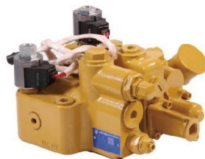
YCDC*-15 系列多路换向阀 DIRECTIONAL VALVE 公称压力 NOMINAL PRESSURE : 20MPa 公称流量 NOMINAL FLOW RATE : 65L/min 阀杆行程 SPPOOL STROKE : 7+7mm
