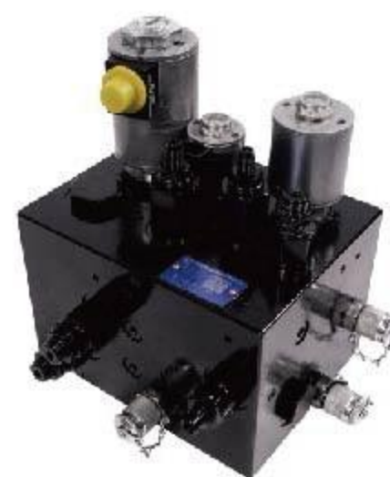
HCFK43 液压集成阀块 HYDRAULIC BLOCK VALVE 最大流量 MAX FLOW RATE : 50L/min 最大压力 MAX PRESSURE : 210bar 安全阀设定压力 SAFETY VALVE SETTING PRESSURE : 15MPa 蓄能器充液压力 ACCUMULATOR FILLING PRESSURE : 10~13MPa 控制电压 CONTROL VOLTAGE : DC24V
