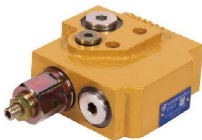
PDF02 单路充液阀 ONE-WAY LIQUID FILLING VALVE 公称压力 NOMINAL PRESSURE : 20MPa 公称流量 NOMINAL FLOW RATE : 65L/min
