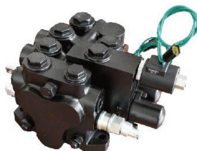
YCDC*-20 系列多路换向阀 DIRECTIONAL VALVE 公称压力 NOMINAL PRESSURE : 20MPa 公称流量 NOMINAL FLOW RATE : 160L/min 阀杆行程 SPOOL STROKE : 8+8mm
