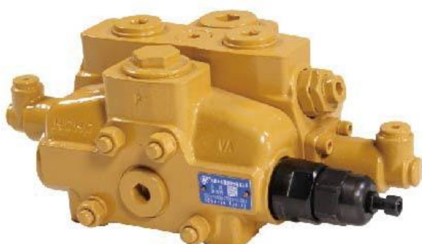
SDVA*-40 系列多路换向阀 DIRECTIONAL VALVE 公称压力 NOMINAL PRESSURE : 31.5MPa 公称流量 NOMINAL FLOW RATE : 120L/min 阀杆行程 SPOOL STROKE : 7+7mm
