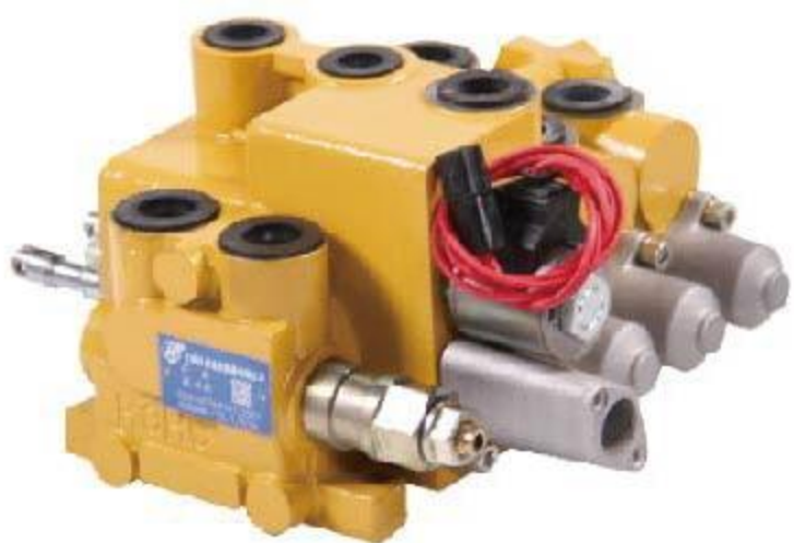
DCDB*-15 系列多路换向阀 DIRECTIONAL VALVE 公称压力 NOMINAL PRESSURE : 20MPa 公称流量 NOMINAL FLOW RATE : 65L/min 阀杆行程 SPPOOL STROKE : 7+7mm
