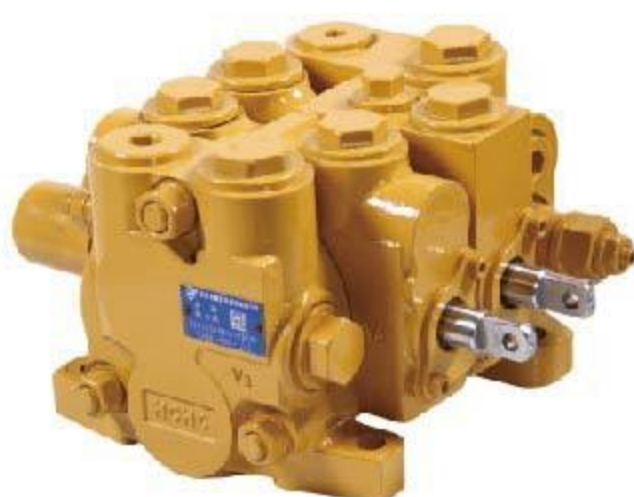
YCDB*-20 系列多路换向阀 DIRECTIONAL VALVE 公称压力 NOMINAL PRESSURE : 20MPa 公称流量 NOMINAL FLOW RATE : 160L/min 阀杆行程 SPOOL STROKE : 8+8mm
